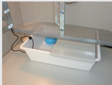
Umidificatore ultrasuoni ad una membrana One membrane ultrasounds humidifier
